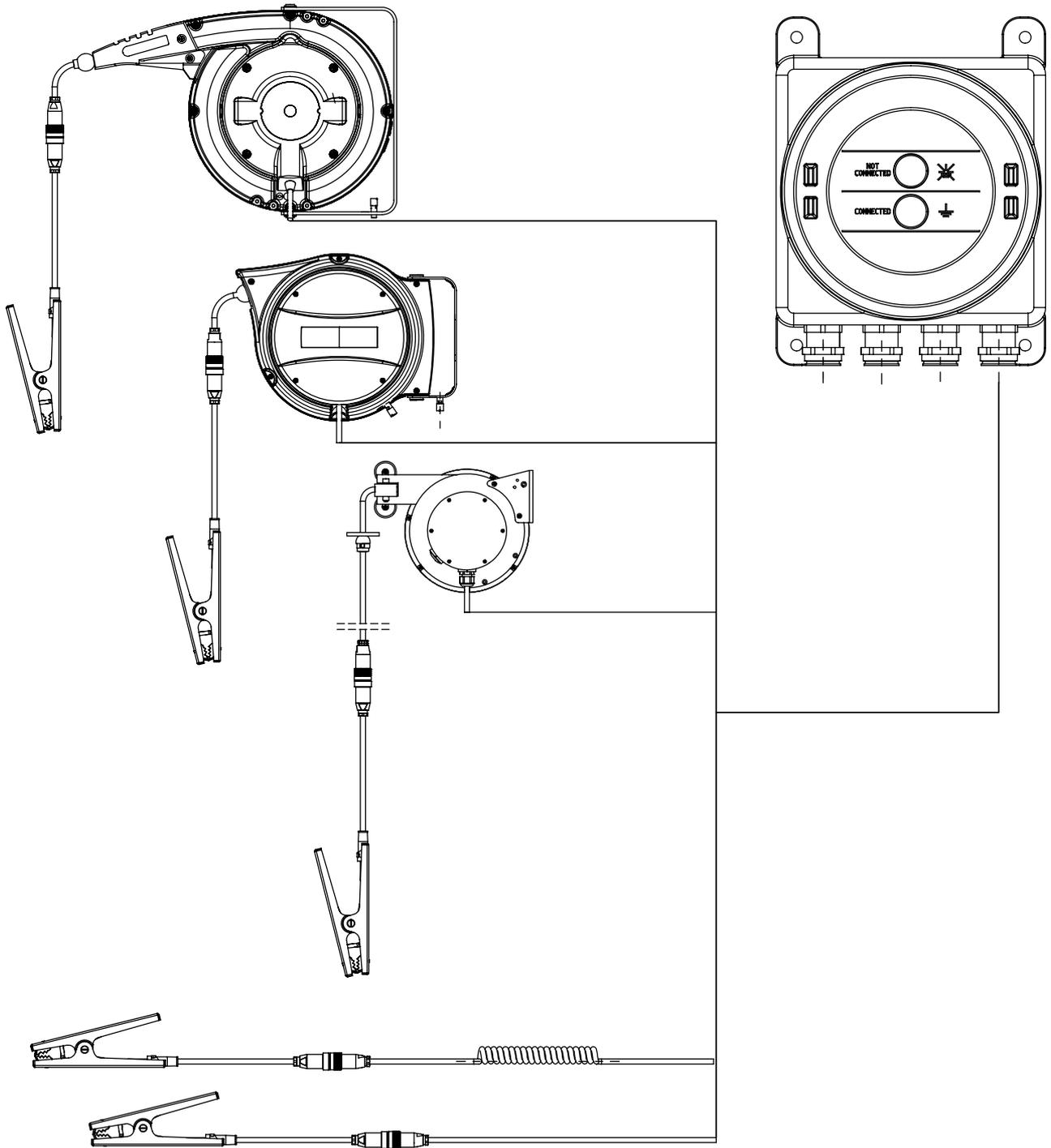
Abb. 1: Übersicht Erdüberwachungssystem TCB040-V2 mit Kabelrücklaufrollen und Zangen
