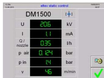
Das Informationsmenü zeigt die aktuelle Spannung und Strom der Hochspannung, die versprühte Wassermenge pro Düsen in einer Stunde, den Druck der Druckluft zur Zerstäubung des Wassers und den Eingangswasserdruck der Anlage an.
