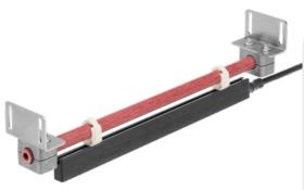
Dieser Typ Halterung wird dann eingesetzt, wenn wegen einem fehlenden Träger oder einer fehlenden Querverbindung in der Maschine eine Elektrode ab einer Gesamtlänge >1000 mm nicht mit 3 Montagesätzen/Montageclips befestigt werden kann. Die Elektrode erhält mit dem GfK-Stab eine fixe Position und kann durch Lösen der Klemmstücke in jede gewünschte Winkellage gebracht werden. Anschließend wird mit den Klemmstücken die Position fixiert.
