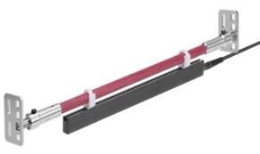
Bei der Halterung mit Lochblechen kann die Elektrode in den verschiedenen Positionen des Lochbleches eingerastet werden. Die möglichen Positionen werden durch die verschiedenen Ausführungen der Lochbleche bestimmt. Die Lochbleche werden an stabilen Maschinenteilen angebracht. So wird die Kraft des gefederten Zapfens aufgenommen und die Elektrode in eine stabile Lage gebracht.
