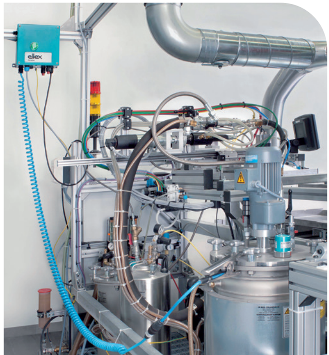
Active Erdung an Containern oder Fässern
