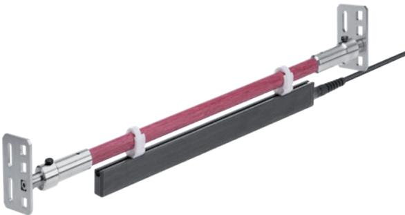
Dans le cas du support avec tôles perforées, l'électrode peut être enclenchée dans les différentes positions de la tôle perforée. Les positions possibles sont déterminées par les différentes versions des tôles perforées. Les tôles perforées sont fixées sur des parties stables de la machine. Ainsi, la force du pivot à ressort est absorbée et l'électrode est placée dans une position stable.
