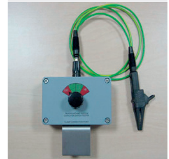
Testeur TCT pour contrôler le bon fonctionnement du système de mise à la terre TERRACAP TCB040
