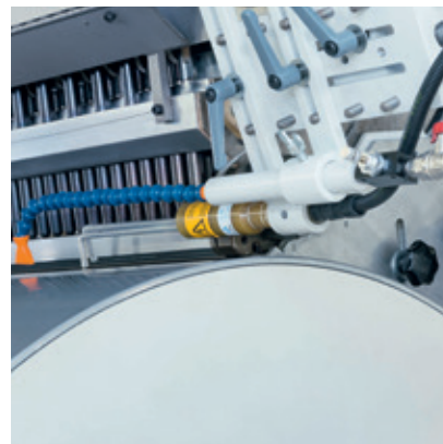
Folienproduktion ohne "Neck-in" Foto: SML GmbH
