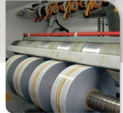
Entladesystem an Rollenschneidemaschinen
