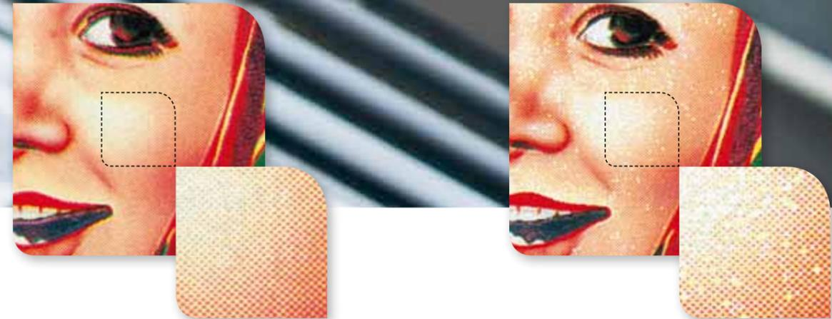
Missing Dots sind ein auffälliges Merkmal minderer Druckqualität sowohl auf Papier, Karton und Kunststoffolie. Mit Druckhilfesystemen wird das Ergebnis Punkt für Punkt perfekt.
