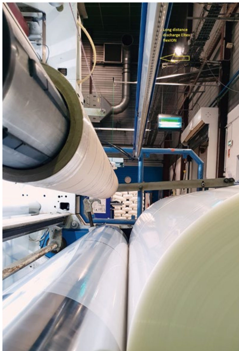
Eingebaute Entladeelektrode flexION air am Wickler
