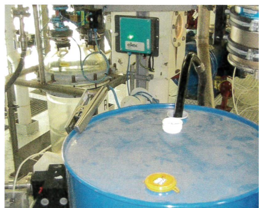
Aktive Erdung mit dem Terra-Control-System TUE30
